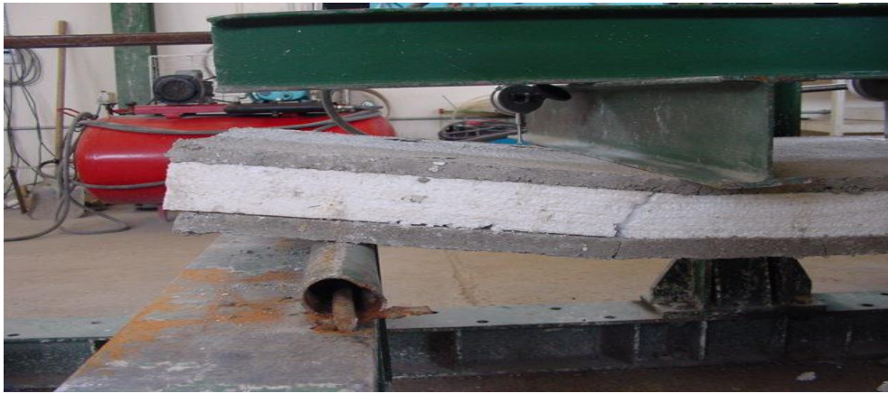
شکل ۵: شکست نمونه پانلی در ناحیه زیر بار متمرکز
