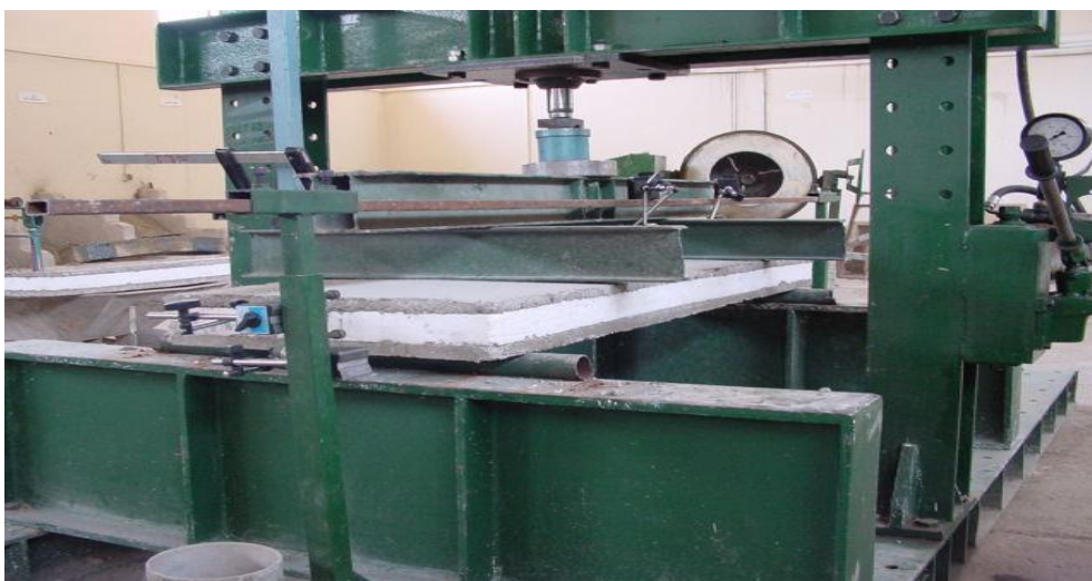
شکل ۲ : نحوه استقرار پانل و جک
