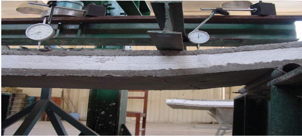
شکل ۴: خمش پانل تحت بار و ایجاد ترکهای اولیه
